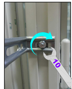
Serrage de l'écrou avec une clé de 10.
