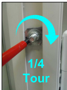
Finir le 1/4 de tour à l'aide d'un tournevis plat
